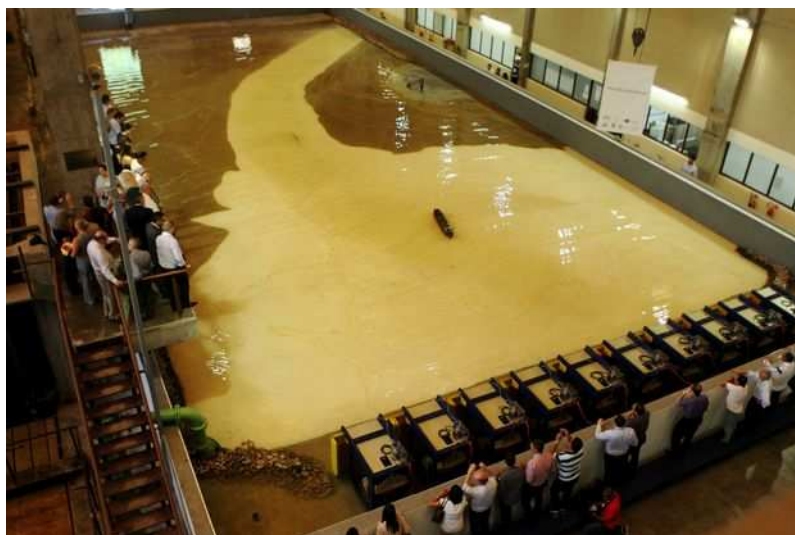
O simulador físico de ondas espectrais reproduz o Trecho 1 do canal de navegação (Foto: Carlos Nogueira/A Tribuna)
